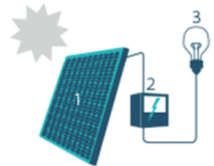
1. Zonnepaneel | 2. Omvormer | 3. Elektrische toestellen
